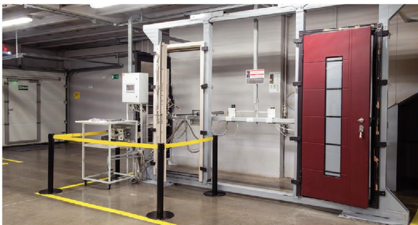
Проверка конструкции в стенде циклических нагрузок (открывание и закрывание)
