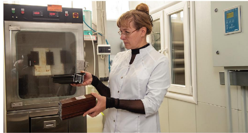
Проверка материалов и комплектующих на устойчивость к агрессивной среде (камера соляного тумана)
