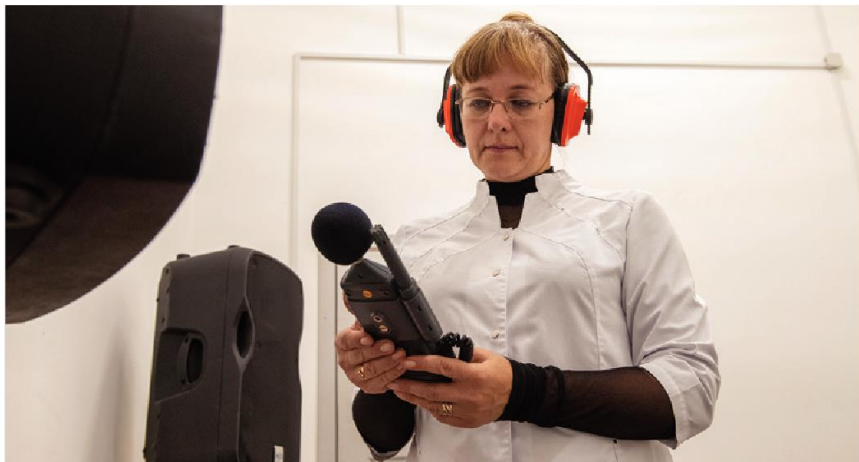
Проверка дверей на уровень звукоизоляции
