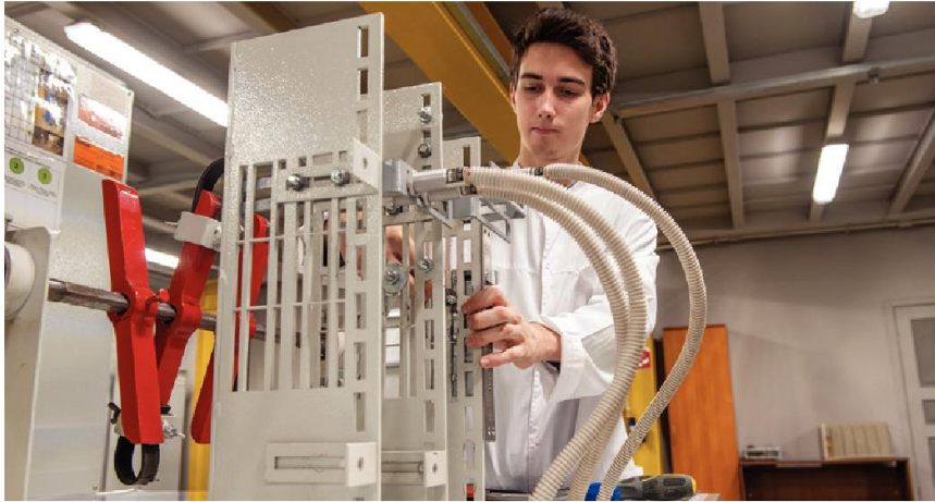
Проверка замков и фурнитуры на износостойкость
