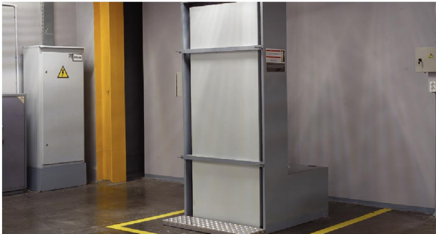
Стенд проверки покрытий на устойчивость к воздействию ультрафиолета и нагревания
